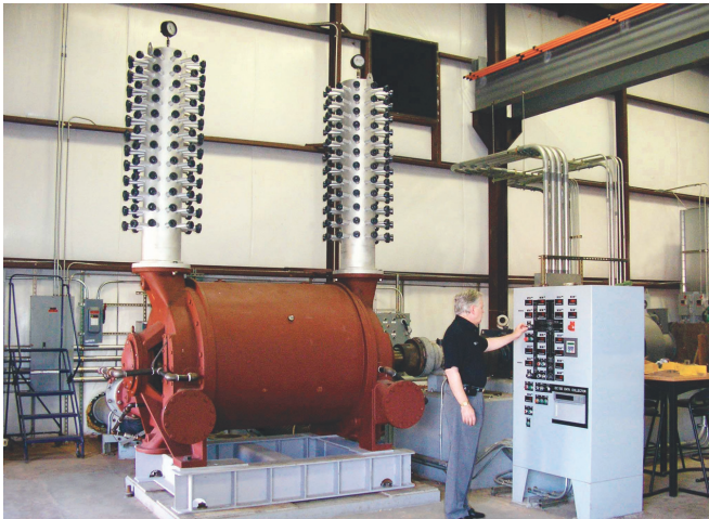
Una bomba de puerto cónico con dos entradas de Vooner FloGard probada en las instalaciones para pruebas de Charlotte, NC.
