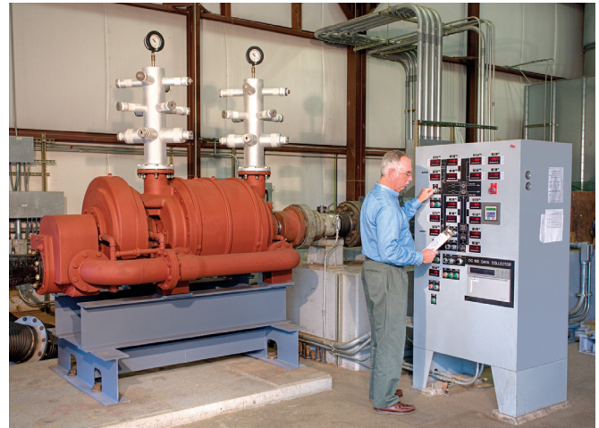
Una bomba de dos etapas de alto vacío de Vooner FloGard durante una prueba
